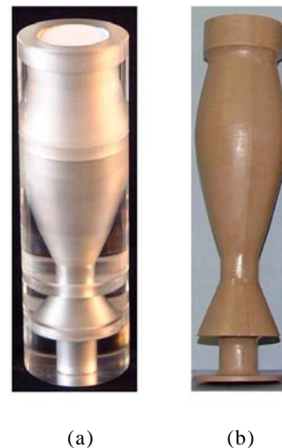
Fig. 1 筒型声道模型. いずれも母音の/a/(下が喉頭側, 上が口唇側). (a) 円柱の素材を中心軸に沿ってくり抜いた透明アクリル製（初代のモデル）, (b) 肉厚が一定（厚さ 2.5 mm）のケミカルウッド製.
